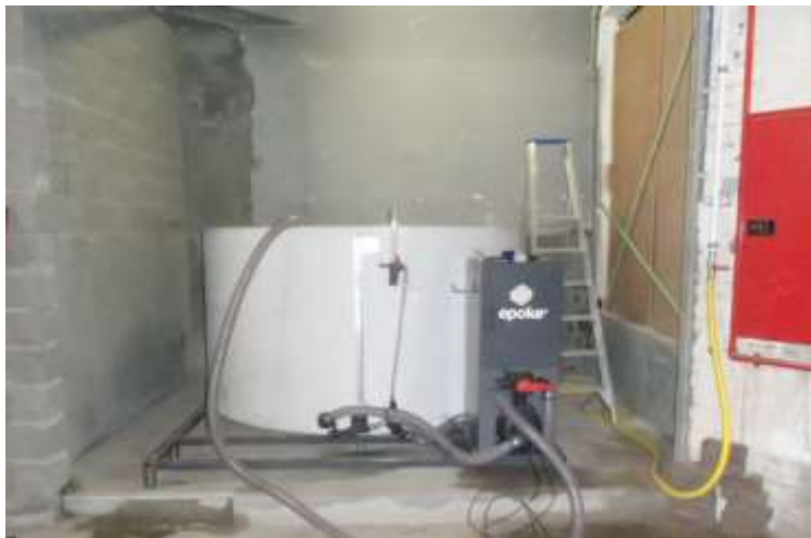
Cuve de mélange de la saumure et gicleur de dispersion
