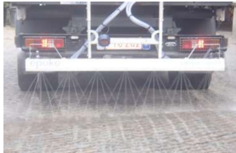
Cuve de mélange de la saumure et gicleur de dispersion
